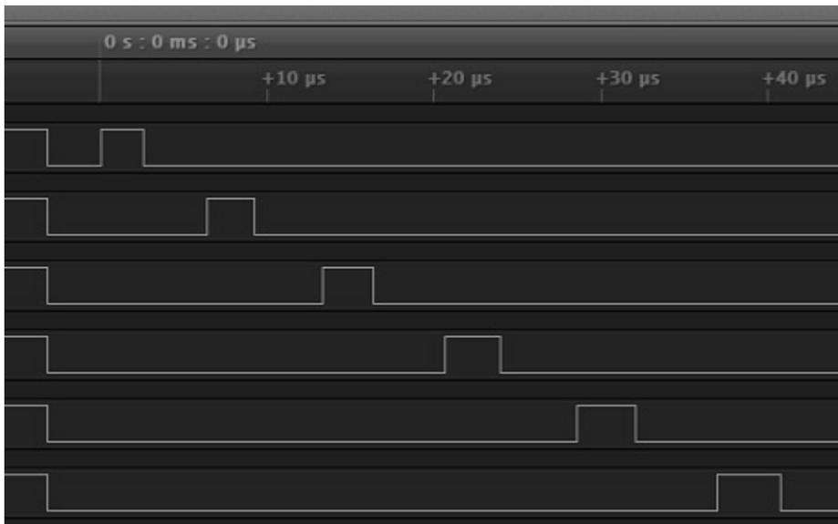
Man sieht sofort: Die High-Phasen  $T_H$  der einzelnen Ausgänge (Diese entsprechen jeweils der Zeit für die Ausführung des Ausschaltvorgangs!) sind unterschiedlich lang und werden mit zunehmenden Wert von  $i$  größer. Ausmessen von  $T_H$  ergab:
